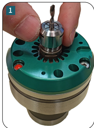
Fig. 2: Tighten ER 11 nut by hand
