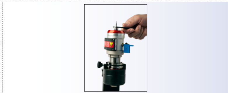
Fig. 34. Loosening ER11 nut
